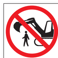
Ref. 473 Prohibido circular o permanecer en el radio de acción de la excavadora
