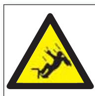
Ref. 355 Peligro Caída distinto nivel
