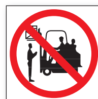
Ref. 457 Prohibido permanecer debajo de la carga
